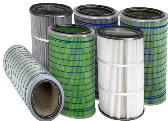
Camfil produziert und vertreibt HemiPleat® und DuraPleat® Austausch-Filterpatronen, die in allen industriellen Trockenabscheidern mit ovalen Filterpatronen eingesetzt werden können. Die in das plissierte Filtermedium eingearbeiteten Kunststoffperlen sorgen dafür, dass die Faltungen der Filterpatronen offen bleiben, somit höhere Standzeiten aufweisen und mehr Staub abscheiden als andere handelsübliche Filterpatronen.
